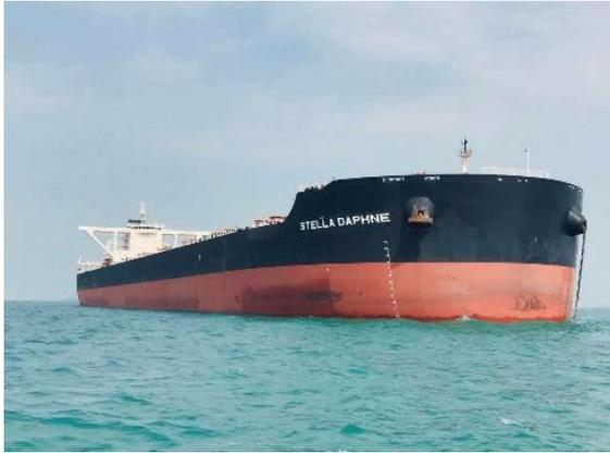
超大型矿石运输船 (VLOC – Very Large Ore Carrier)
