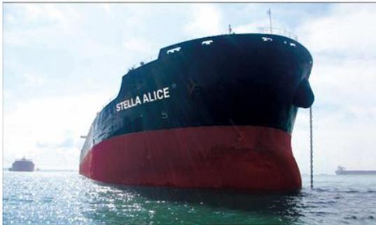
好望角型18万吨散货船 (Capesize) 主机: MAN B&W 6S70MC-C7
